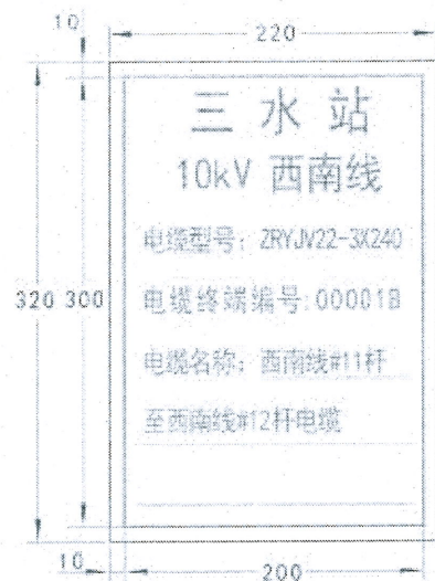
电缆终端标志牌
